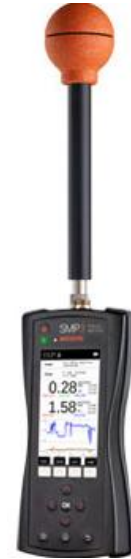
Širokopojasni instrument za merenje jačine el. polja
