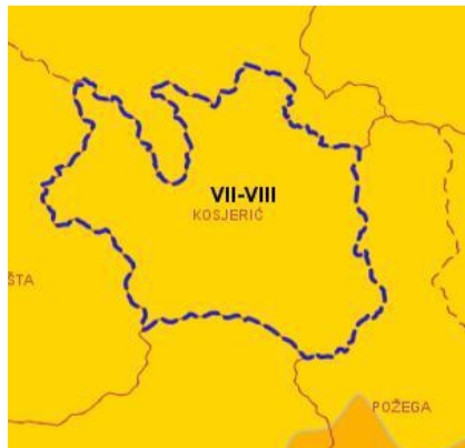
Слика бр. 1: Карта сеизмичког хазарда за повратни период 475 година изражен у степенима макросеизмичког интензитета
